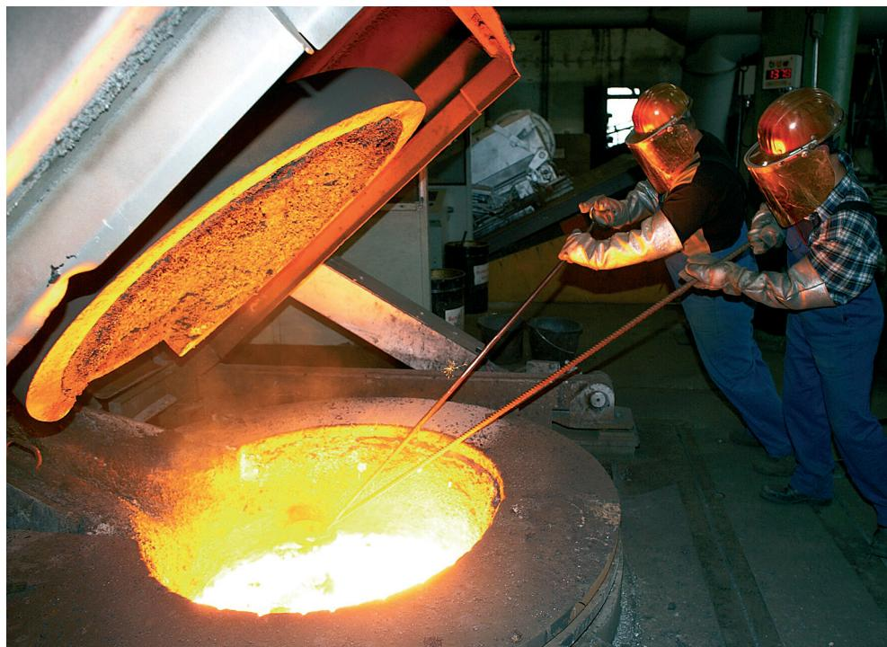
Slika 1.2. Električna induktionska peć – toplina kao korisni oblik energije
